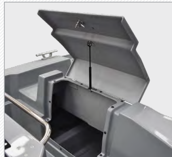
Le coffre arrière très accessible permet, lors de la phase d'aménagement, de monter des systèmes et des batteries dans cette zone, mais aussi, pendant le moulage de la coque, de joindre le pont à la coque par l'intérieur: une garantie fondamentale de résistance aux contraintes très élevées auxquelles ces types de bateaux sont soumis.
